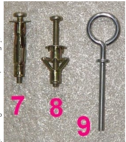
afb. 18 - 10 hollewandplug (7), dito gezet (8), en (9) een schroefvoog voor hollewandplug
