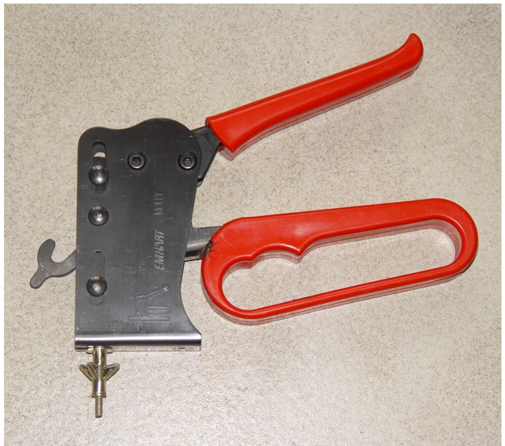
afb. 18 - 9 Pluggenzettang, met gezette plug. De dieptebezenzer is hier uitgeklaapt omdat die in dit geval niet nodig was -> hollow wall anchor setting tool. The depth limiter (left), not needed in this application, is swung out
