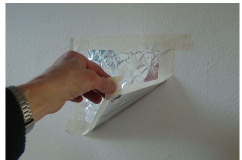
afb. 17.1 - 3 Beoordelen van de testfolie
