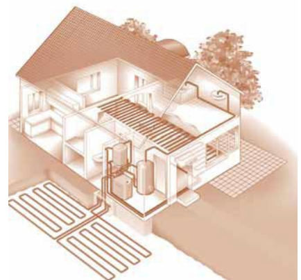
afb. 12.1.2 - 22 Horizontale water/water warmtepomp
