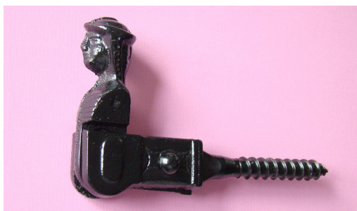
afb. 09.4.6 - 11 Arrêt de volet, modèle Tourniquet, hier als inschroefmodel met instelbare aanslag (groene pijl)
