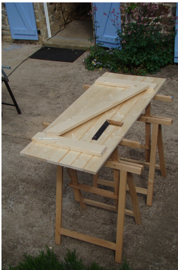
afb. 009.4.5 - 3 uitsparingen voor de écharpe op de barres aftekenen -> mark the cutouts for the diagonal brace
