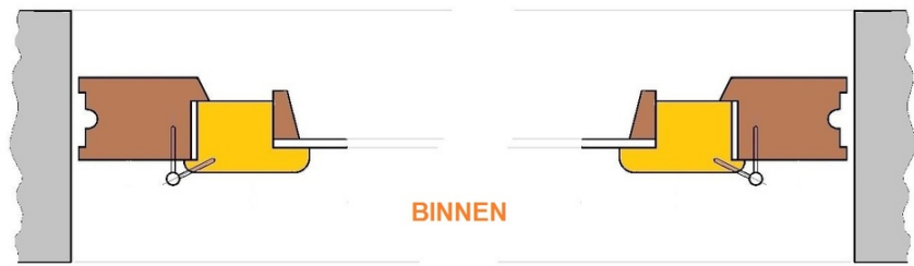
afb. 09.2 - 8 Pose en tunnel -&gt; Placing 'en tunnel'
