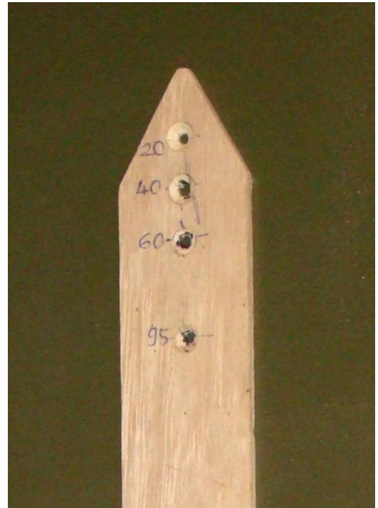
afb.08.3.4 - 14 mijn afschrijfgereedschap: latje met gaten -> my marking tool, a piece of scrapwood with holes
