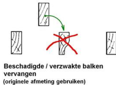
afb. 08.2.3 - 3 Balken waar nodig vervangen
