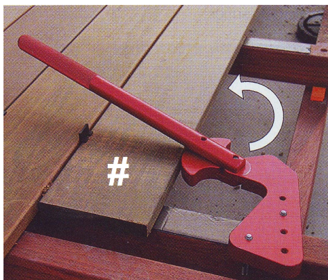
afb. 08.1.3 - 9 Een andere serre-lames à levier. Hier is, omdat het om steigerplanken op een terras gaat, dus zonder messing en groef, geen 'martyr' nodig.
