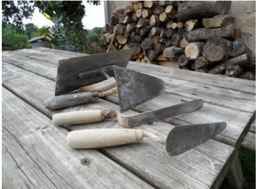
afb. 07.2 - 7a Voeggereedschappen, gekopieerd van Bram van Zanten - de door mij gekoesterde pannenstrijker ontbreekt hier!
