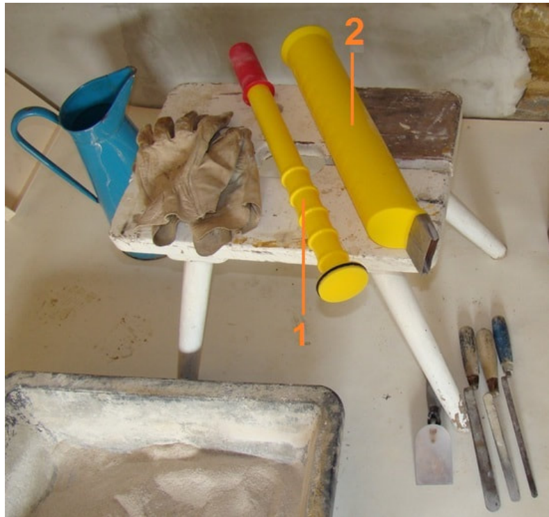
afb. 07.2 - 8a Pointmaster: de onderdelen. (1) de zuiger/plunjer, (2) de cilinder met spuitmond. Op de grond mijn voegspijkers.
