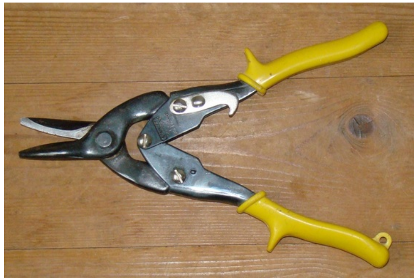
afb. 07.1.1 - 2a getande bliksschaar met dubbele hefboom -> Metal scissor cutter with serrated blades and double lever
