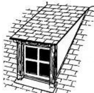
lucarne rampante ou en chien couché
