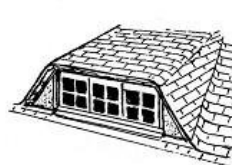
lucarne en trapèze ou rampante à jouées biaisées (couverture en bardeaux d'asphalte)
