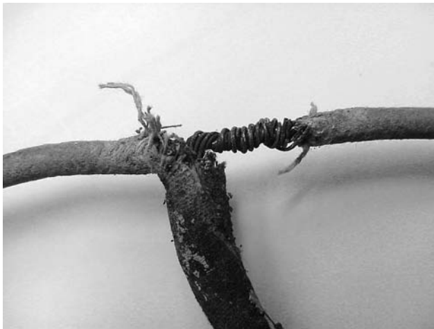
Figure 202 : Une ancienne épissure (interdit)
